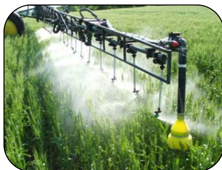
Figure 5. Buses Turbo FloodJet dirigées alternativement vers l'avant et vers l'arrière lors des pulvérisations de fongicides destinées à combattre la fusariose de l'épi.
