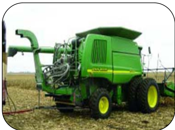
Figure 1. Moissonneuse-batteuse modifiée pour récolter des résidus de culture
